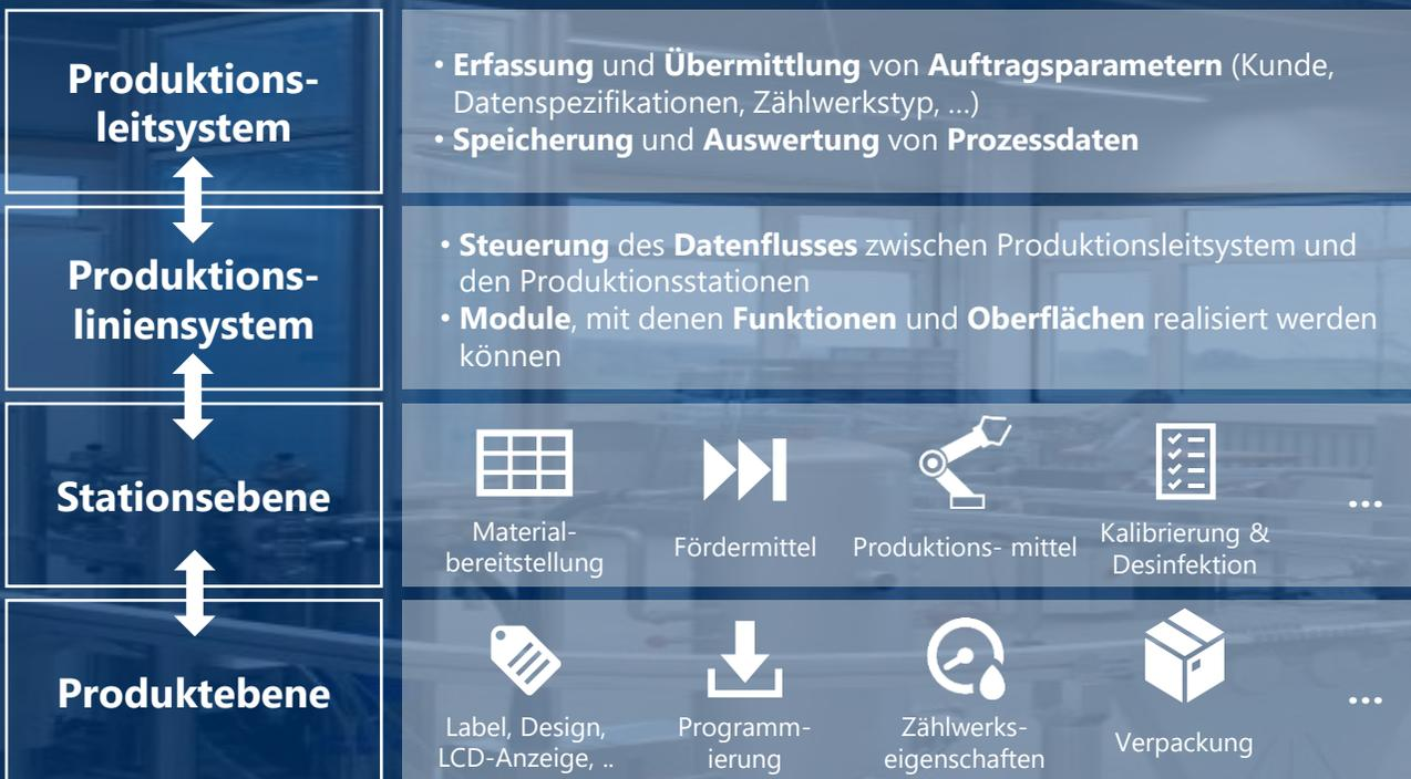
Enorme **Flexibilität** und **Schnelligkeit** bei Änderungen und Erweiterungen durch **Baukastenprinzip** der **Steuerungssoftware** gegenüber Einzelprogrammierung (Zeitersparnis amortisiert Lizenzgebühr)
